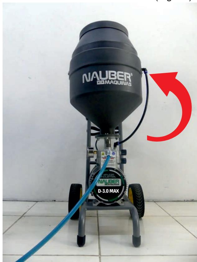
9.5. Ligue a máquina e deixe circular a tinta por 10 segundos para eliminar o ar interno do sistema pela mangueira de retorno.
