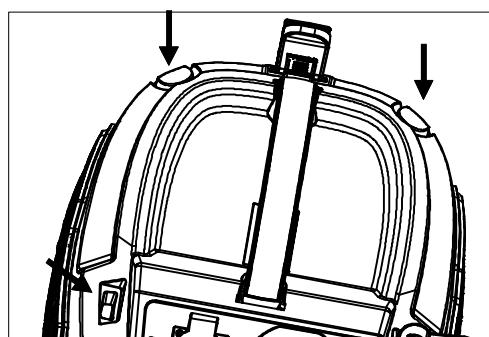
O suporte de acessórios no tubo metálico de expansão é encaixado no slot da cabeça da máquina, e outros acessórios podem ser inseridos nos demais encaixes.
