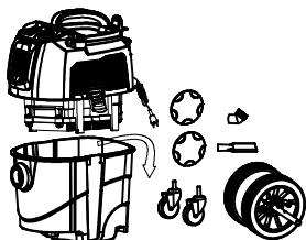
1. Solte a trava para abrir a tampa superior e retire as rodas e os acessórios.
