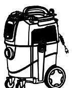
5. Coloque a tampa (parte superior do aspirador) e feche com a trava.
