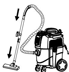
6. Insira o conector da mangueira na entrada de sucção da máquina, gire no sentido horário para fixar. Depois, conecte o cotovelo ao tubo de metal e a outra ponta do tubo na escova de piso.
