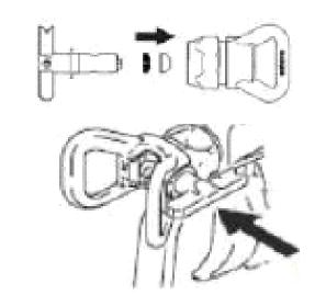
4. Após montado o bico e a vedação no porta bico parafuse o conjunto na pistola de pintura.
