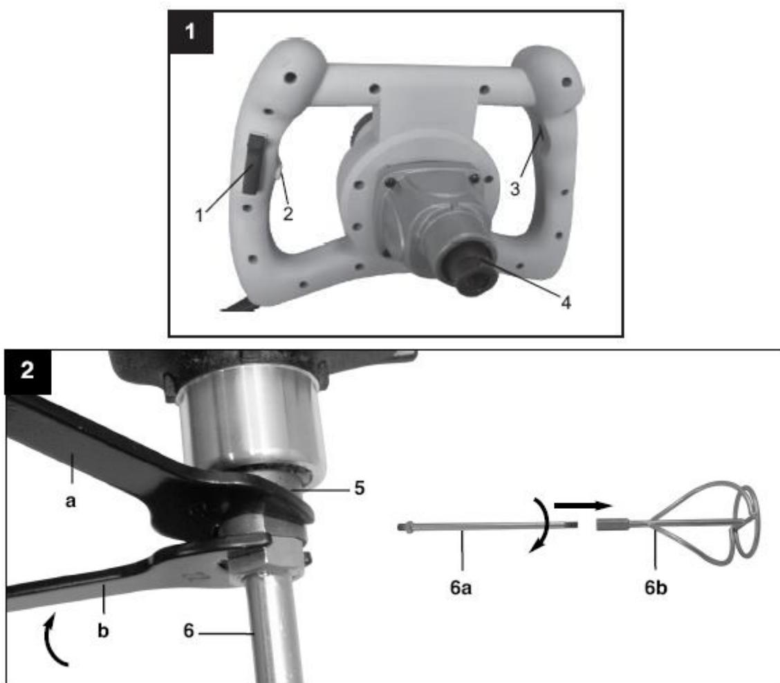
Primeiramente, rosqueie a haste (6<sup>a</sup>) com a pá (6b), apertando com uma chave. Em seguida, rosqueie a haste com a pá no misturador. Use as duas chaves inglesas (a e b) para fazer isso. Use uma das chaves para segurar o suporte do misturador no lugar e depois use a segunda chave para apertar o misturador. Continue na sequência inversa para retirar a haste.
